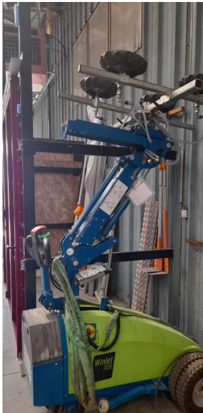
L'utilisation de matériel de manutention et de levage permet un positionnement précis d'éléments lourds et volumineux.
